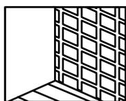
Une ossature en bois doit être appliquée sur les murs en mauvais état, les tasseaux doivent être espacés au maximum de 60cm verticalement et 80cm horizontalement selon la surface concernée.
