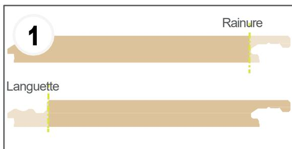
Les panneaux Hydrolock® sont fournis en général avec un bord à languette et un bord à rainure. Lors de l'installation d'un profilé le long d'un panneau, le bord à rainure ou à languette doit être coupé pour permettre de l'insérer.
