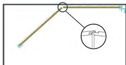
Poussez le panneau dans le profilé de Type A et appuyez fermement contre le mur, nettoyez tout excès de silicone dans le coin.
