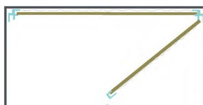
Mettez du silicone sur l'autre côté du profilé de type A. Répétez les étapes 2 et 3, en mettant un profilé d'Embout si nécessaire.
