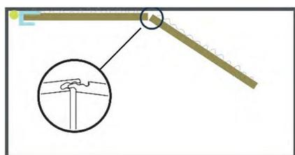
3. Installez les autres panneaux en utilisant le joint Hydrolock® pour une finition sans jointement visible.
